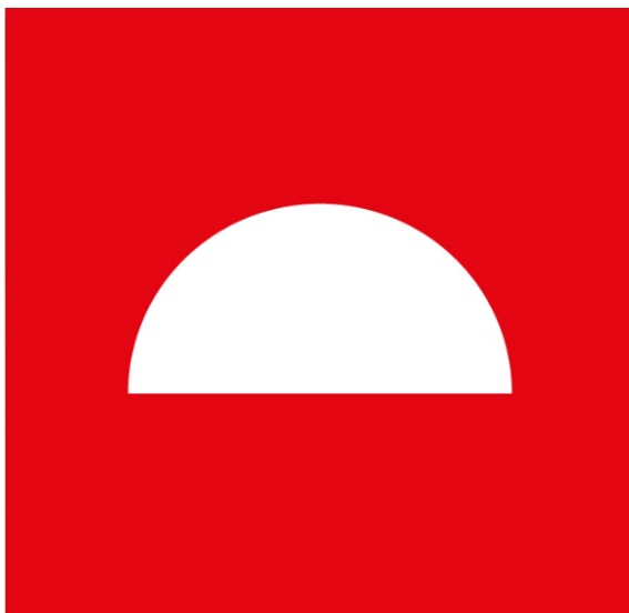
Figur 3. Skylt för säkerhetsbrytare, kompletteras med text om hur avstängning sker
